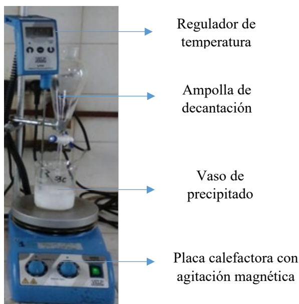
Figura II.1: Equipo del laboratorio empleado para la síntesis sol-gel de fotocatalizadores.
