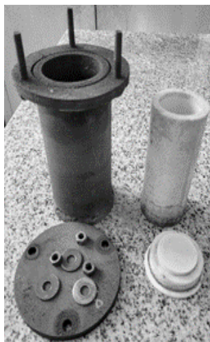
Figura II.3: Autoclave de acero inoxidable y teflón utilizado en el tratamiento hidrotérmico.
