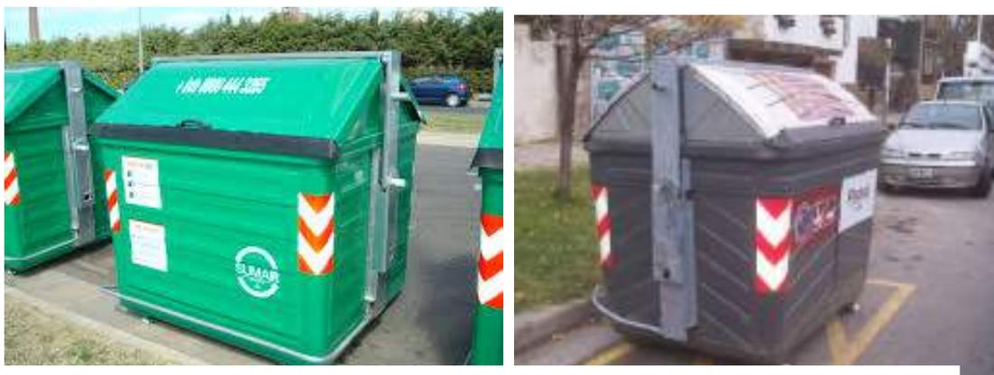
**Figura 7.7:** Modelo de contenedor de carga lateral .Fuente registros propios del autor, 2024
