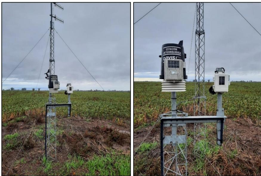
Figura 5.1: Estación meteorológica automática de la SRSCC.
