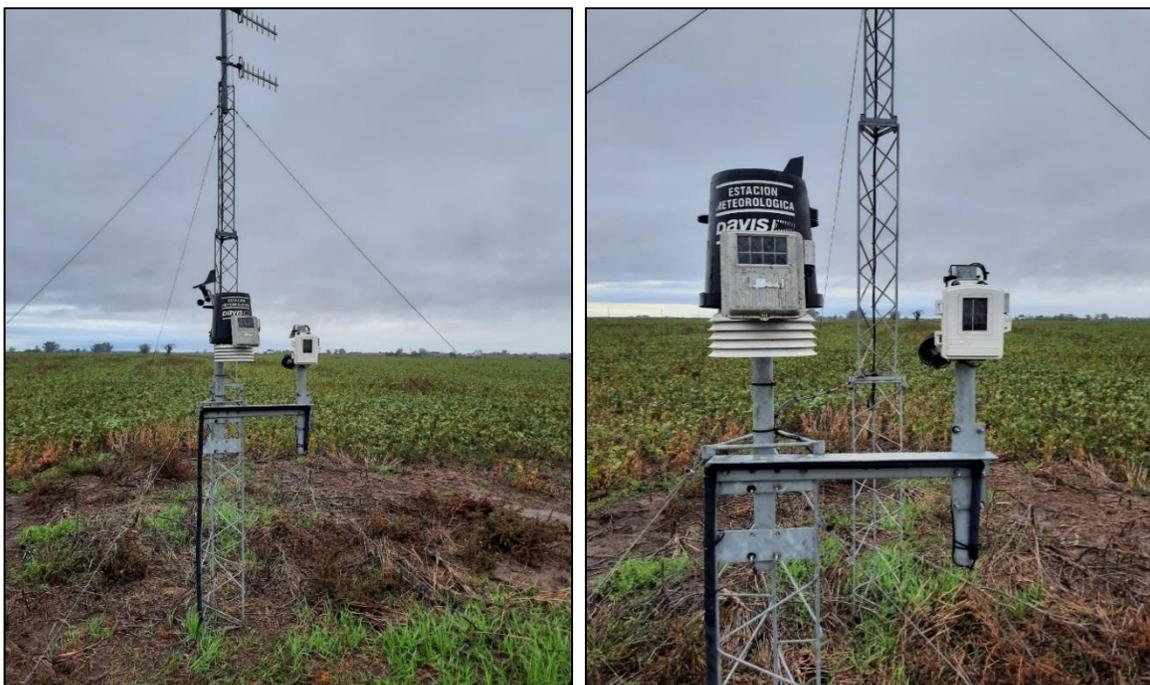
Figura 2: Estación meteorológica automática de la SRSCC.
