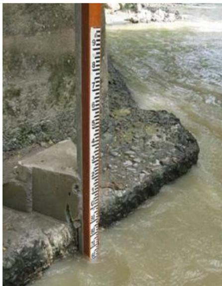
Figura 3: Limnómetro (escala hidrométrica) y Limnógrafo.
