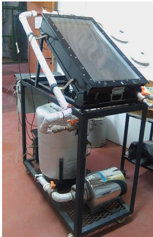
Figura 3.3. Fotografía del Reactor Solar escala planta piloto.
