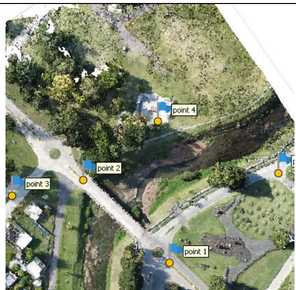
Figura 5-5 Nube de puntos y puntos de control puente Mitre
