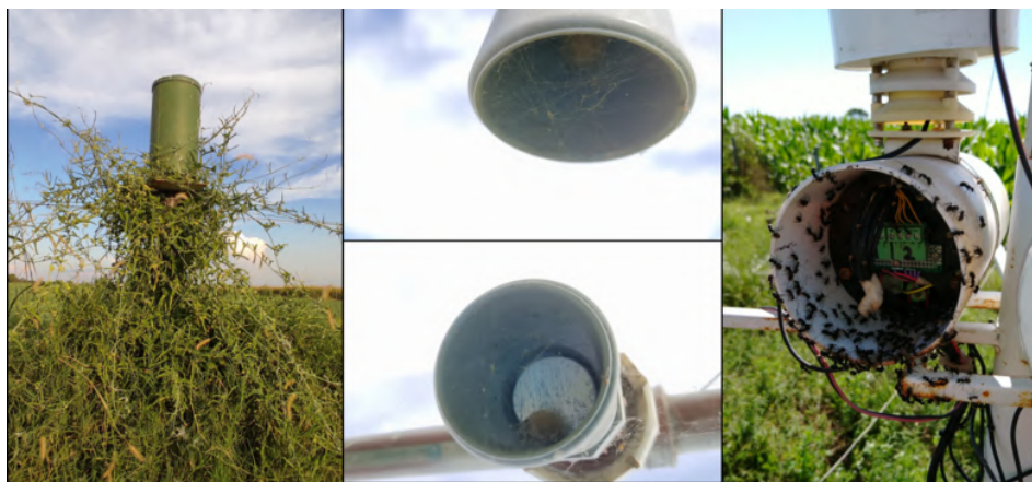
Figura 1.20: Afectación en el funcionamiento de los equipos debido a insectos
