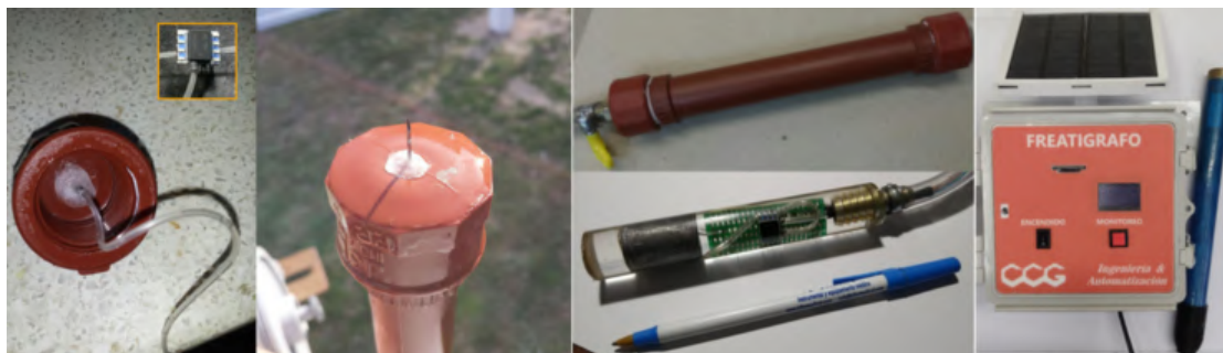
Figura 1.12: Evolución de sonda freatimétrica hasta su versión final.
