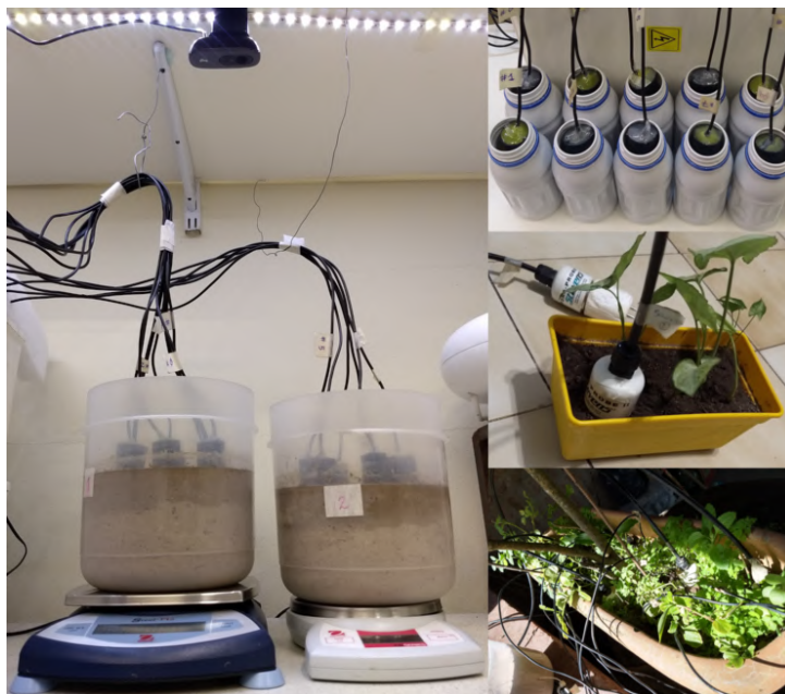
Figura 1.13: Ensayos varios de validación y calibración de sensores de humedad del suelo
