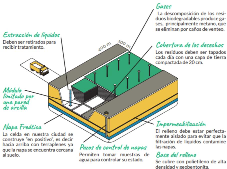
Figura 4.12: Partes del método de trinchera o zanja
