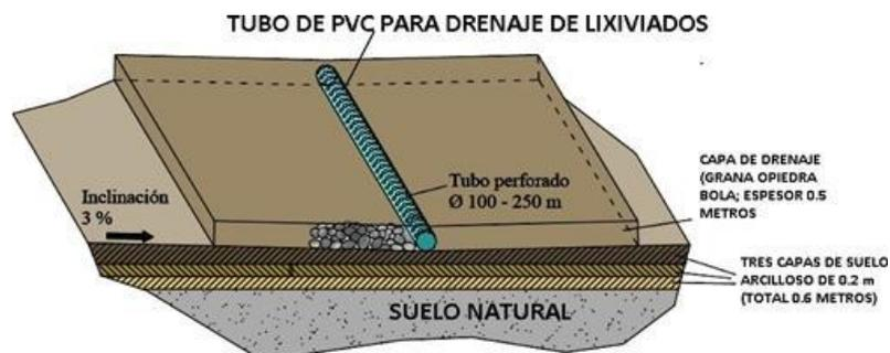
Figura 4.10: Sistema de drenaje interno para lixiviados con tubería de PVC
