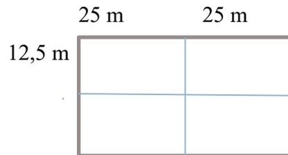
Figura 9.52: Dimensiones de cada módulo del Relleno
