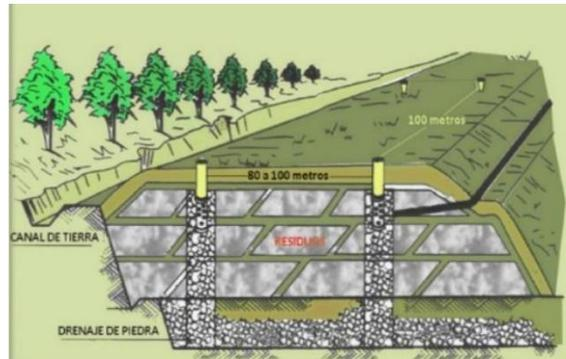
Figura 4.11: Sistema de drenaje de gases
