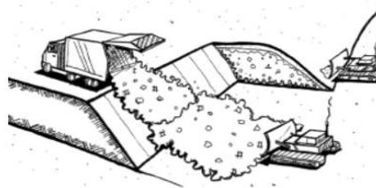
Figura 4.14: Método de rampa
