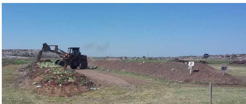
Figura 4.16 – Sistema abierto de compostaje
