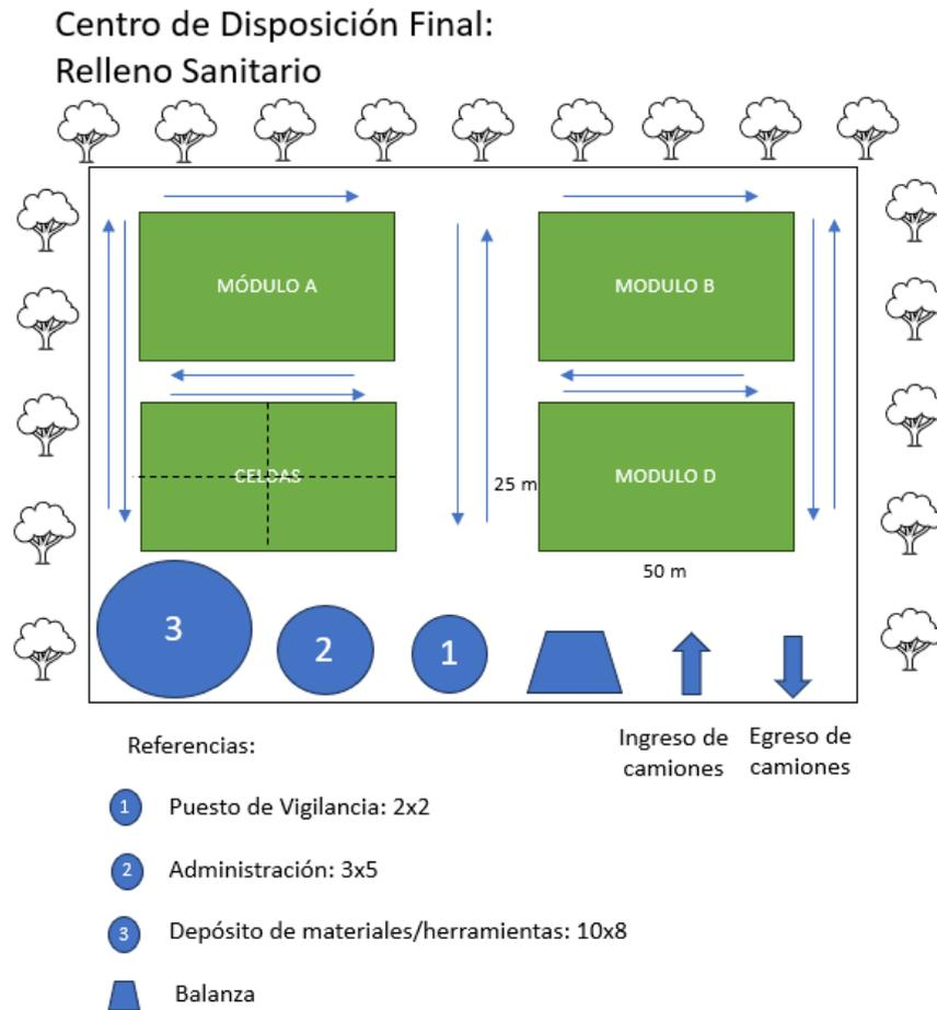
Figura 9.51: Modelo de Planta – Relleno Sanitario.
