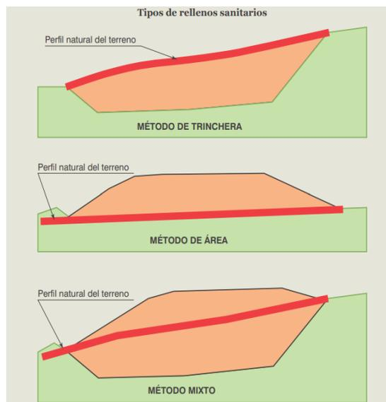
Figura 4.15: Tipos de Relleno Sanitario
