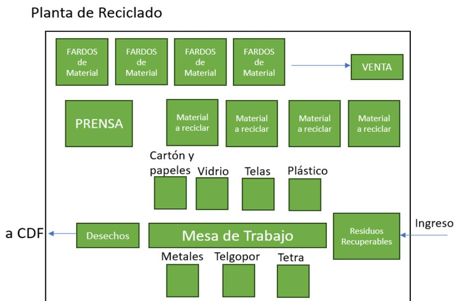
Figura 9.53: Modelo de Planta de Tratamiento de Residuos Recuperables.
