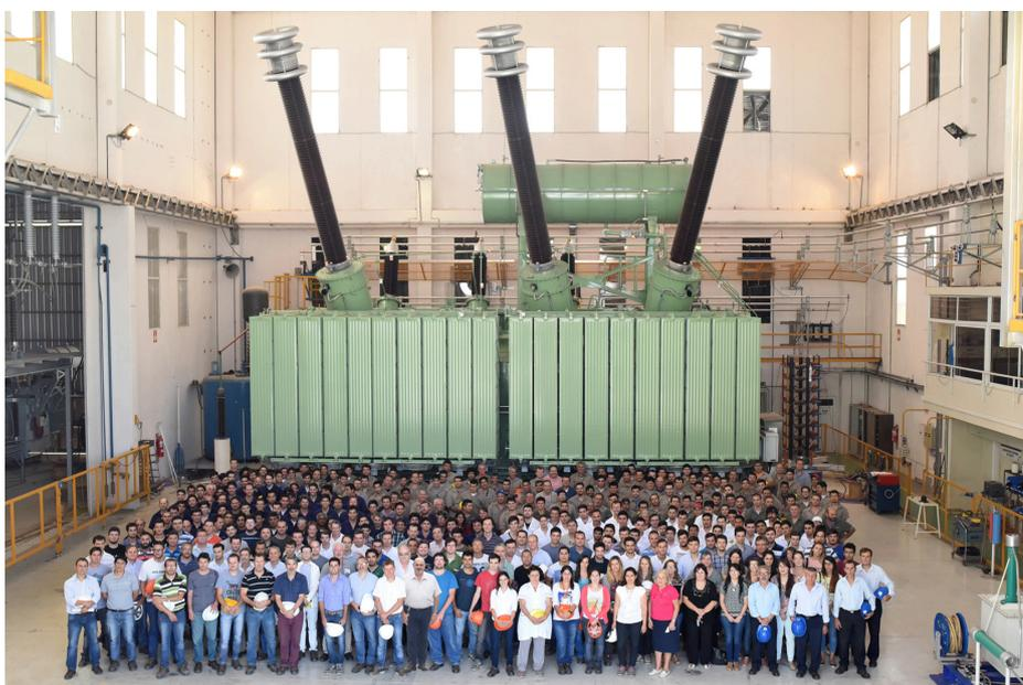
**Figura 1.4:** Transformador de potencia de 500[kV] - 300[MVA] fabricados por la empresa Tadeo Czerweny. 10[m] de largo, 4[m] de ancho y 6[m] de alto, 212 toneladas 100.000[l] de aceite mineral YPF-64® USD 3.5 millones.
