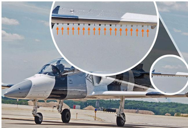
**Figura 2.2:** Generadores de vórtices instalados en el ala de un avión.
