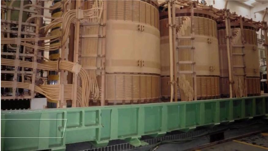
**Figura 1.6:** Proceso de encubado de un transformador de potencia.
