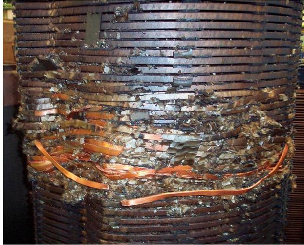
**Figura 1.11:** Bobina quemada de un transformador.
