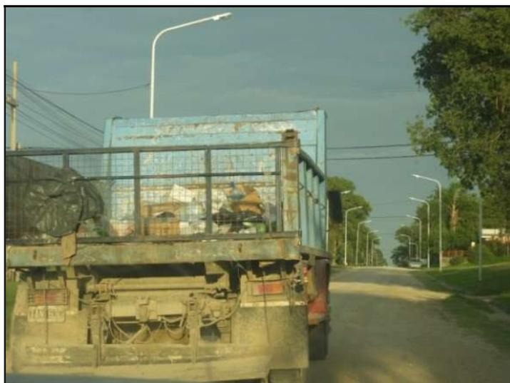
Figura VII.3 Fotografía camión con vuelco hidráulico trasero
